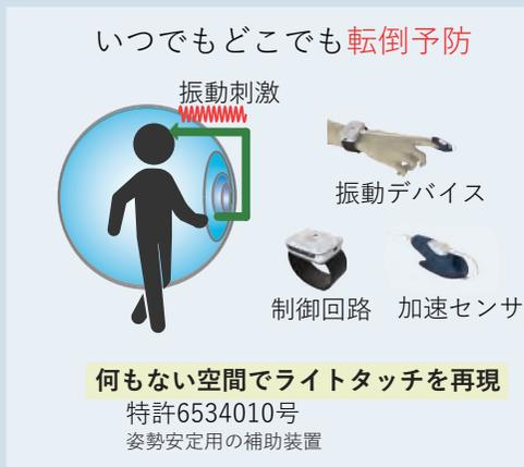
ヒトは指先などで何かに軽く触れていると、転倒しにくくなることが知られています。このライトタッチと呼ばれる現象にヒントを得、身体の周りに仮想的な接触物（仮想壁）を生成し、指先でその壁に触れた際の感覚刺激を指先への振動刺激として与えることで、立位／歩行状態を安定化して重心動揺の少ない状態を保つことができる技術：仮想ライトタッチ（Virtual Light Touch: VLT）法を確立しました。これにより、何もない空間で仮想的な物体への接触状態を作り出すことができ、「いつでも、どこでも、ライトタッチ」が可能となり、ヒトの立位・歩行時の動揺を減少させた転倒予防を開発・提案しました。当社は仮想ライトタッチ研究過程において、指先への振動を急になくすことで身体にふらつきが生じ、そのふらつきの大きさやふらつきからの復帰能力に個人差があることを発見しました。この現象を応用し、転倒リスクや立位に関わる身体・感覚系の機能を評価する方法論として世界初の立位機能検査 StA<sup>2</sup>BLE を提案しています。
